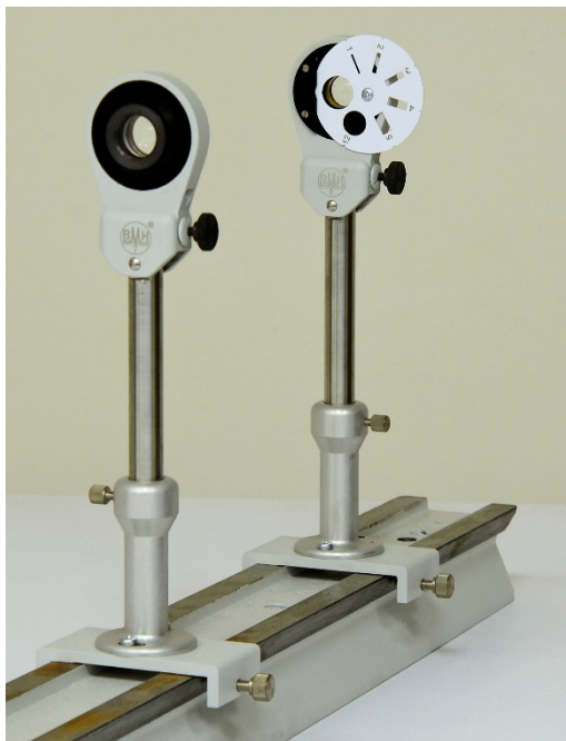
Рис. 2. Система освещения входной щели универсальных штативов типа УШТ-4, «Глобула» и др.;
