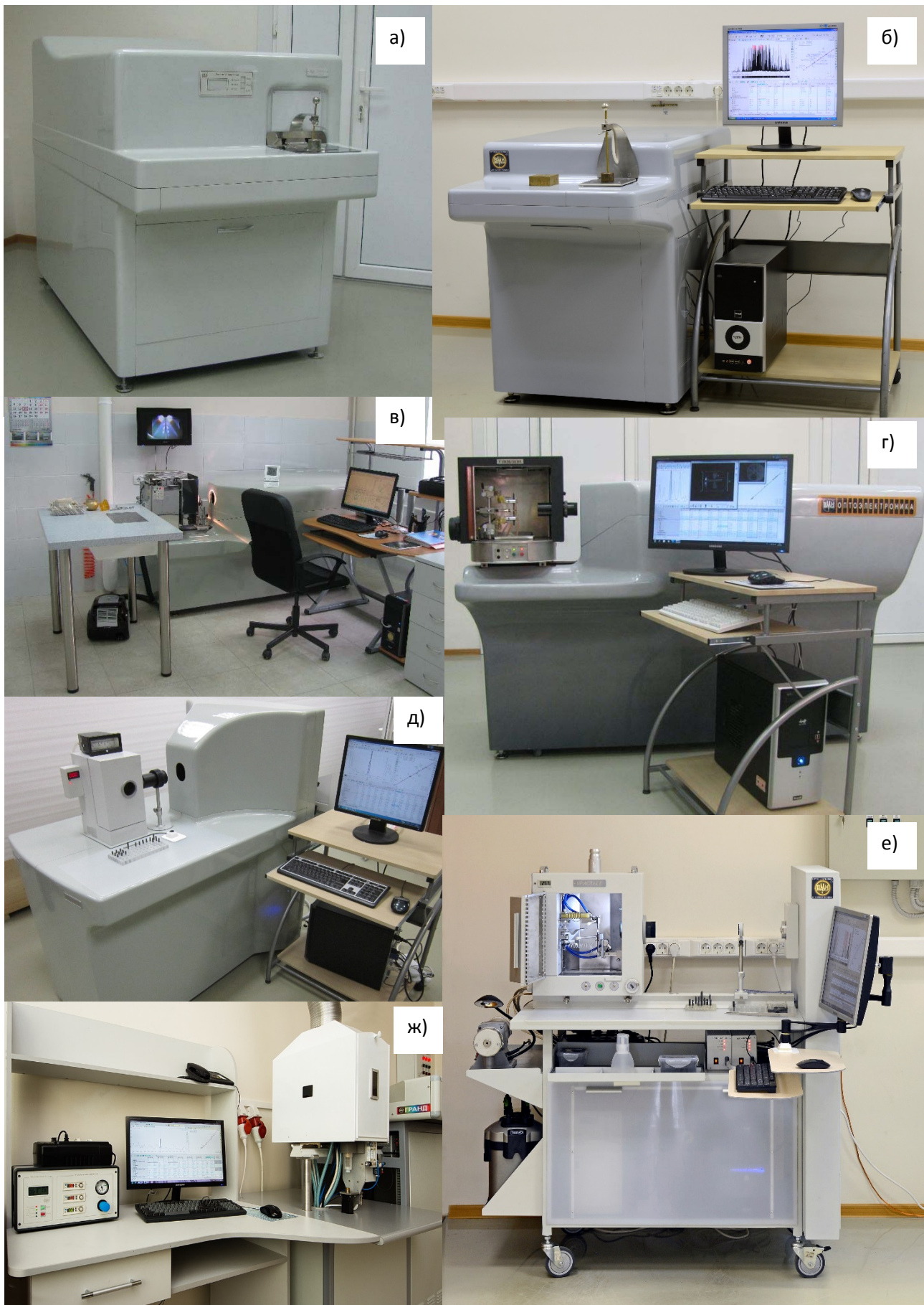
Рис. 1. Внешний вид комплексов АЭС: а – «Гранд-Эксперт», б – «Фаворит», в – «Гранд-Поток», г – «Гранд-Глобула», д – «Экспресс-Ойл», е – «Экспресс-Кристалл», ж – «Гранд-Факел»
